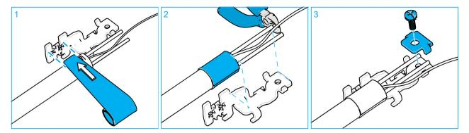
Si le diamètre est inférieur à 9 mm ou si la gaine est fine, ajoutez 5 tours de silicone auto-amalgamant. Retirer le papier de protection de la bande auto-amalgamant. Étirer la bande entre 50% et 300 % tout en enveloppant la bande autour du câble. Vous assurer que le ruban est positionné là où sera placé le collier de serrage.
