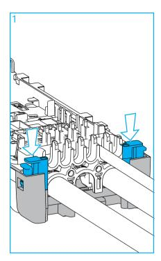
Positionner l'organiseur dans le boîtier avec les câbles de raccordement vers le haut. Appuyer fermement sur les verrous latéraux pour verrouiller l'organiseur dans le boîtier. Lorsqu'un clic est remarqué, l'organiseur est correctement verrouillé.
