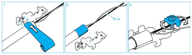
Si le diamètre est inférieur à 9 mm ou si la gaine est fine, ajouter 5 tours de silicone auto-amalgamant. Retirer le
