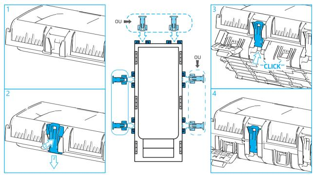
Pour un positionnement vertical, les charnières peuvent être installées à gauche, à droite ou au-dessus. Pour une configuration en ligne, les charnières peuvent être installées à gauche ou à droite.
