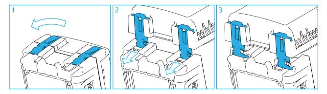
**Remarque :** Si les charnières sont installées en position haute, le couvercle supérieur **ne peut pas être fixé en position ouverte.** Pour accéder à l'intérieur du boîtier, le couvercle doit être détaché.
