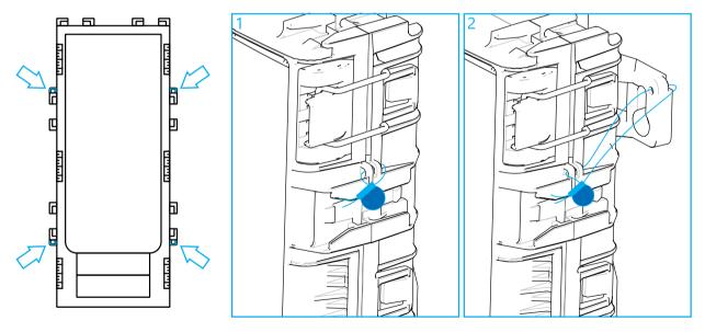
Il y a 4 emplacements pour garantir la fermeture avec un fil de sécurité. Pousser le fil dans les trous sur le couvercle du haut et du bas et sceller le fil par des pratiques locales. La fermeture peut également être fixée au Mobra. Enfoncer le fil dans les deux trous sur le dessus et le couvercle inférieur et en outre, pousser le fil à travers le petit trou sur le Mobra. Sceller le fil par des pratiques locales.
