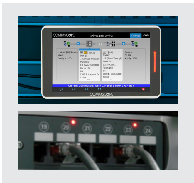
Figura 1: imVision fornisce istruzioni su schermo e una guida visiva sulla connettività delle porte per assicurare che le modifiche vengano effettuate correttamente.
