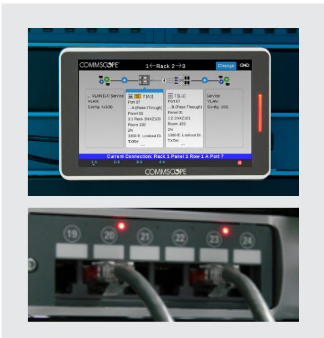
Abbildung 1: imVision bietet Bildschirmmanweisungen und visuelle Anleitungen zu den Anschlüssen, um korrekte Änderungen sicherzustellen.
