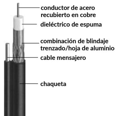
Para las instalaciones aéreas, un **cable mensajero** se integra al cable para soporte. CommScope también ofrece los cables Multi-Reach™ que equivalen a seis UTP aptos para voz, para alimentación o servicio telefónico discreto.
