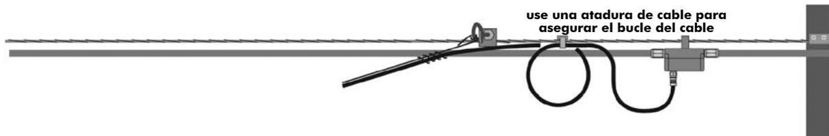
Guarde este cable formando un bucle de alrededor de 6 pulg. (15 cm) de diámetro. Asegúrese que el diámetro del bucle no sea menor que 10 veces el diámetro exterior del cable. Use ataduras de cables para formar y asegurar el bucle al tramo.
