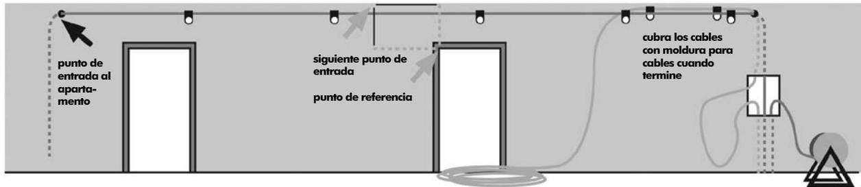
Use colocar el punto de entrada correctamente. Use un localizador de poste de refuerzo para asegurarse de perforar en una cavidad de pared. De ser posible, envíe el cable hacia abajo, donde se ubica la salida. Repase la página 22 para más detalles.
